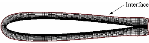
(a) 生成贴体结构网格, 选定初始洞面
